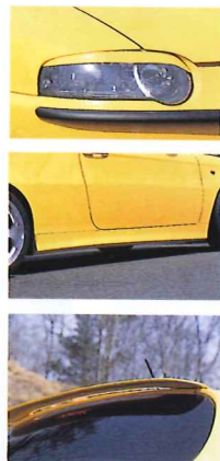
リアスポイラーも一体型ではなく下側に取り付けるタイプ。
