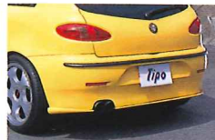
リアスポイラーも一体型ではなく下側に取り付けるタイプ。
