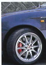
アルミホイールはアウトデルタのオリジナルで、2ピース構造となっている。
