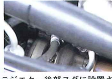
ラジエター後部スグに設置されたターボ本体。上側からだと少し見にくい位置。
